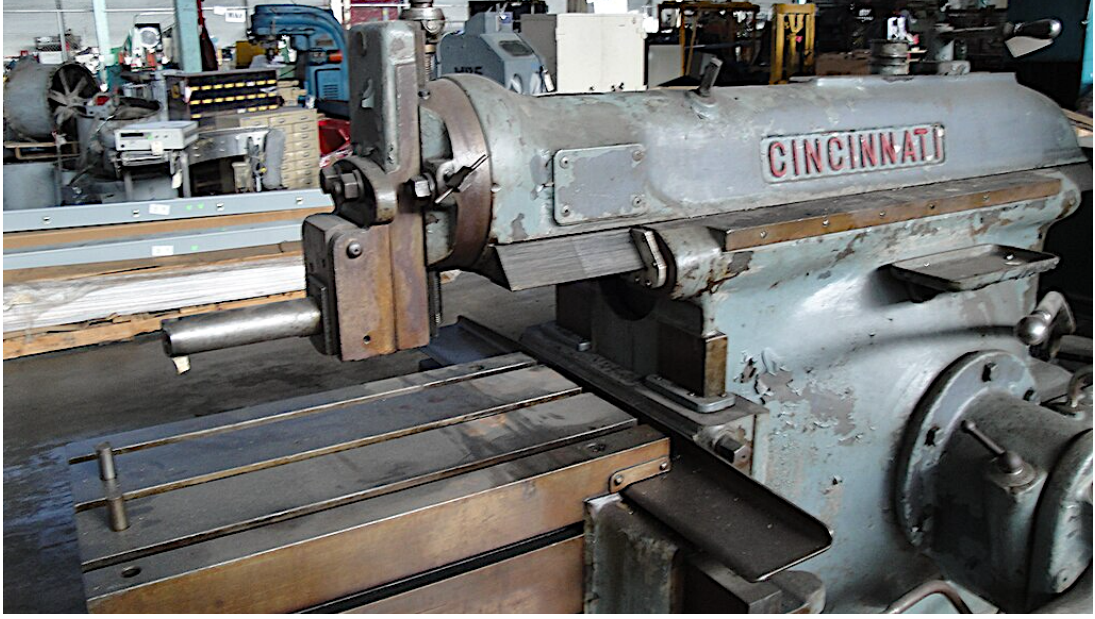
Görsel 1: Planya Tezgahı Üzerinde Boring Bar Kullanımı ( https://w.wiki/Duwq .)
