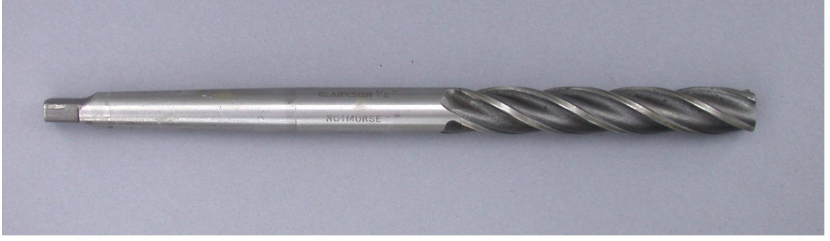
Görsel 7: Spiral Kesme Kenarlı Makine Raybası ( Kaynak: https://w.wiki/Dvs2 )
